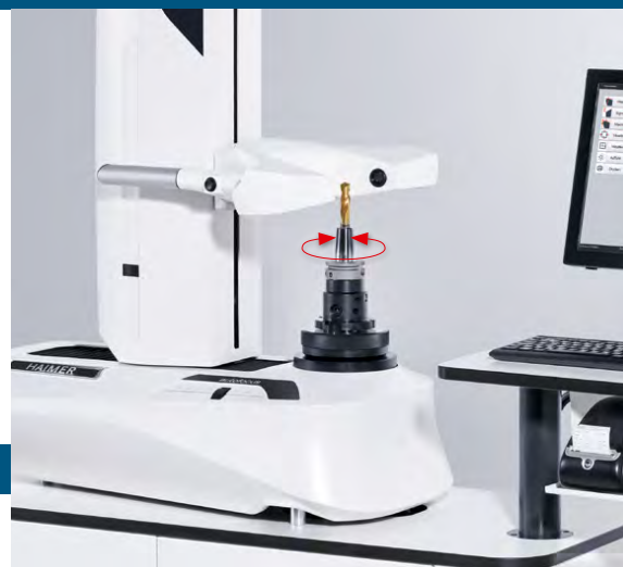
Automatisches Scharfstellen der Schneide Automatic focus on the cutting edge
